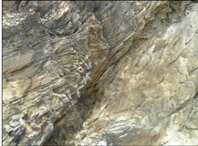
Foto 3.5 - Lote 1: Transição micaxisto e granitos
