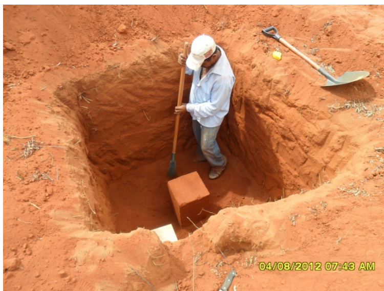
Foto 4.1 - Lote 2: Coleta de bloco indeformado de solo residual
