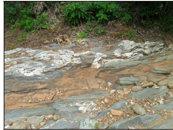
Foto 3.2 - Micaxisto são com veios de quartzo, no fundo do vale, local do Sifão Jardim
