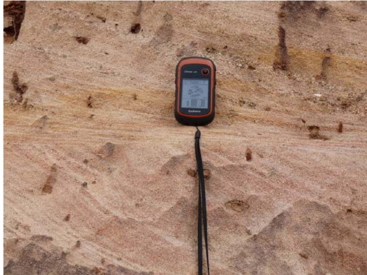
Foto 3.13 - Lote 1: Estratificação horizontal e cruzada em arenitos.
