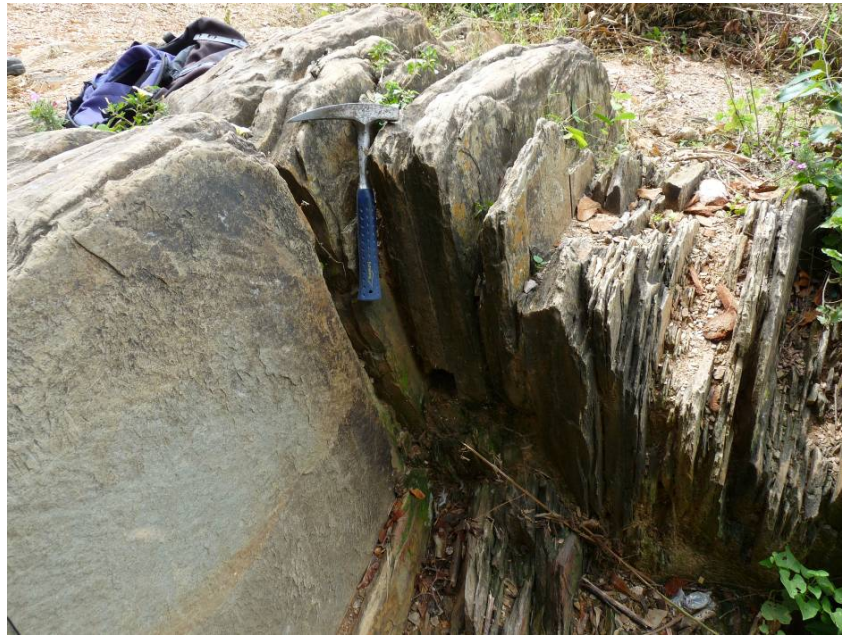
Foto 6.9- Ocorrência de filitos no km 127+530 (próximo Paí Mané)
