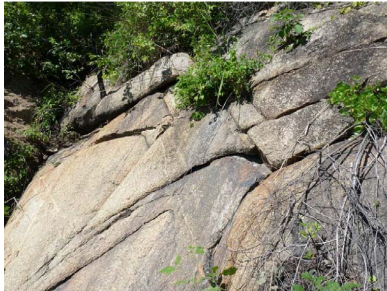
Foto 6.4 - Ocorrência de granito com diaclases abertas km 120+500
