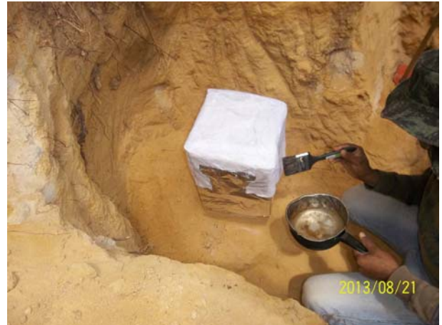
Foto 7.8 – Túnel Arajara: Extração de bloco indeformado
